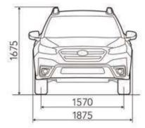
\* Висота моделі в комплектації FIELD становить 1670 мм.
